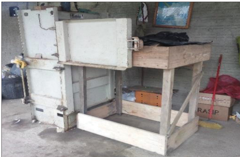
FIGURA 7: MESA COM RODINHAS DESENVOLVIDA PELOS ASSOCIADOS DA ACOMAREM PARA AUXILIAR NO TRANSPORTE DO MATERIAL PARA DENTRO DA PRENSA
