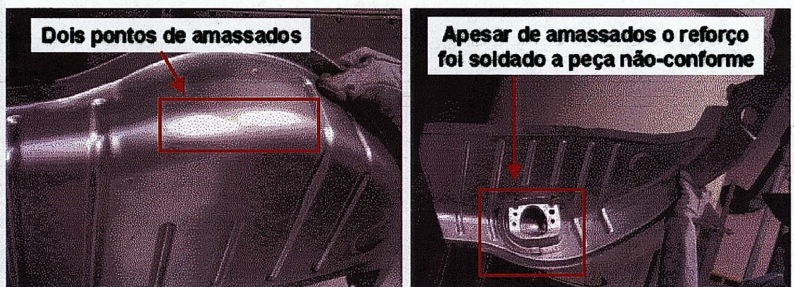
FIGURA 8 - REFORÇO SOLDADO EM PEÇA AMASSADA NA ARMAÇÃO
