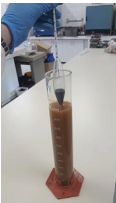
FIGURA A1-1 – MÉTODO DO HIDRÔMETRO DE BOUYOUCOS EM LABORATÓRIO PARA DETERMINAÇÃO DE TEXTURA DO SOLO.
