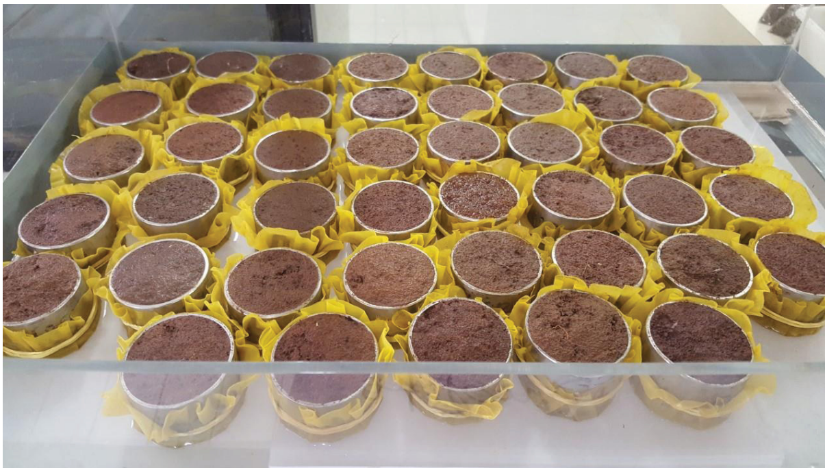
FIGURA A4-1 – AMOSTRAS INDEFORMADAS DE SOLO, COLETADA COM ANEL VOLUMÉTRICO, EM MESA DE TENSÃO DE 60 cm DE COLUNA DE ÁGUA, PARA DETERMINAÇÃO DE UMIDADE NA CAPACIDADE DE CAMPO.
