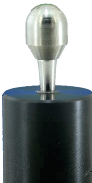
FIGURA 22 - SISTEMA MONTADO PARA ENSAIO: POLIACETAL, IMPLANTE, COMPONENTE E CORPO HEMISFÉRICO.
