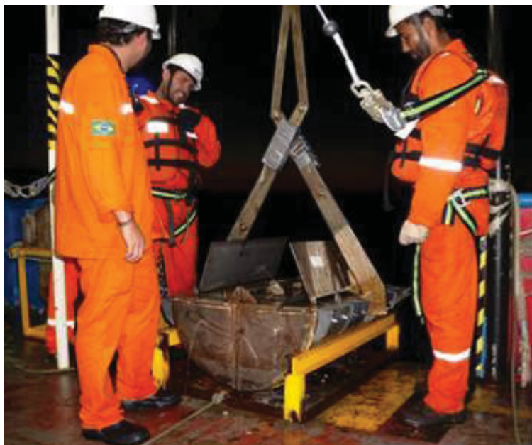
Figura 7. Busca-fundo do tipo van Veen utilizado nas coletas sobre a plataforma continental da Bacia de Campos. Fotografia de Daniel Vicente Pupo
