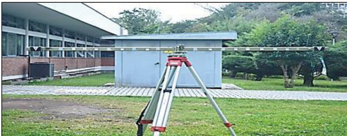
FIGURA 18 - MIRA HORIZONTAL DE ÍNVAR DE 2 METROS
