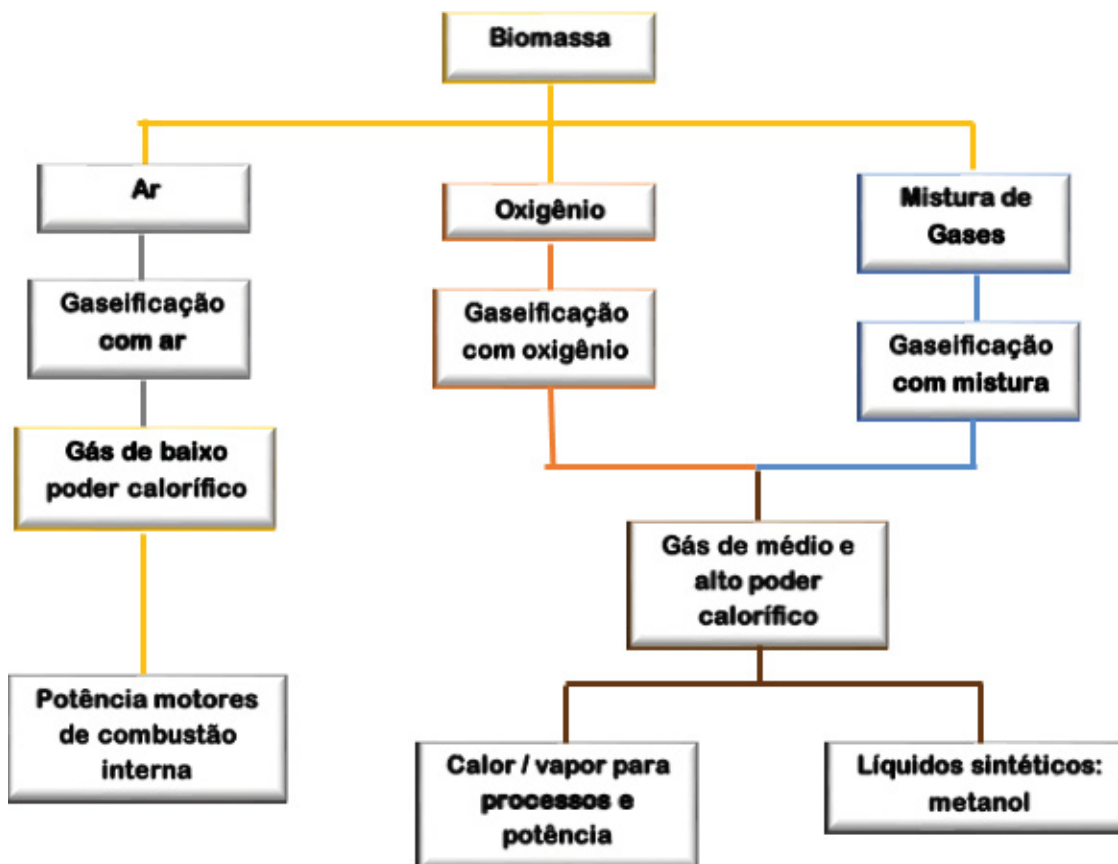
FLUXOGRAMA 3: ROTAS DE GASEIFICAÇÃO DA BIOMASSA FLORESTAL BASEADA NO TIPO DE AGENTE GASEIFICANTE
