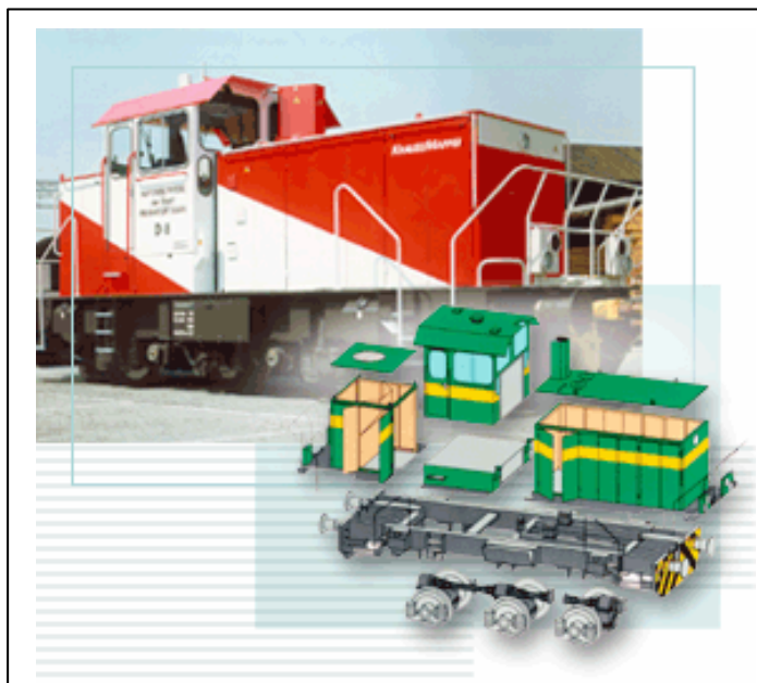
Figura 2.1 - Módulos e plataforma geradores da locomotiva Siemens elétrica ME10.
