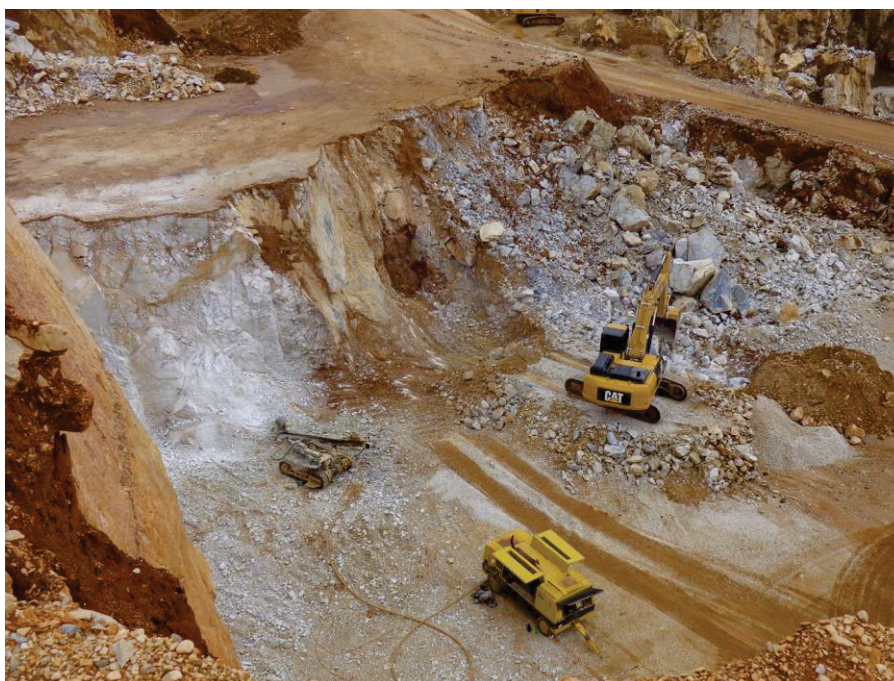
FIGURA 04 - Vista dos trabalhos de perfuração e desmonte sendo executados na mina
