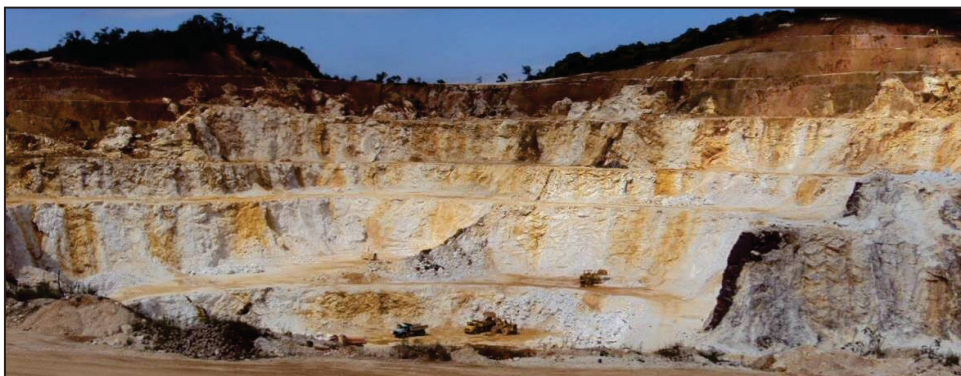
FIGURA 03 – Área de extração mostrando o decapeamento realizado.
