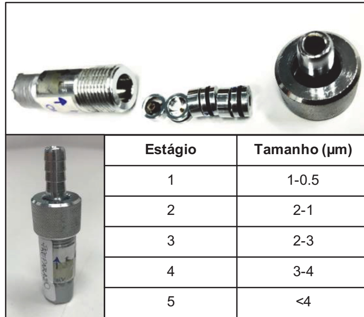
FIGURA 12. IMPACTADOR BATTELLE COM SEUS ESTÁGIOS E TAMANHOS DE AMOSTRAGEM DE PARTÍCULAS.
