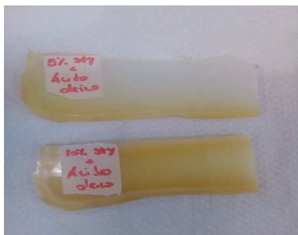
FIGURA 47 - ASPECTO DOS PRODUTOS DE REAÇÃO ENTRE ESTIRENO E ÁCIDO OLEICO
