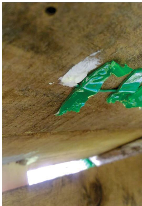
FIGURA 49 TERMOPAR NA SUPERFÍCIE INFERIOR
