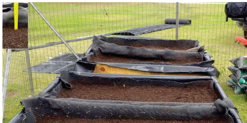
FIGURA 20 – A ESQUERDA DETALHE DA ESPESSURA DO SUBSTRATO, E SUBSTRATO DISTRIBUÍDOS NOS MÓDULOS
