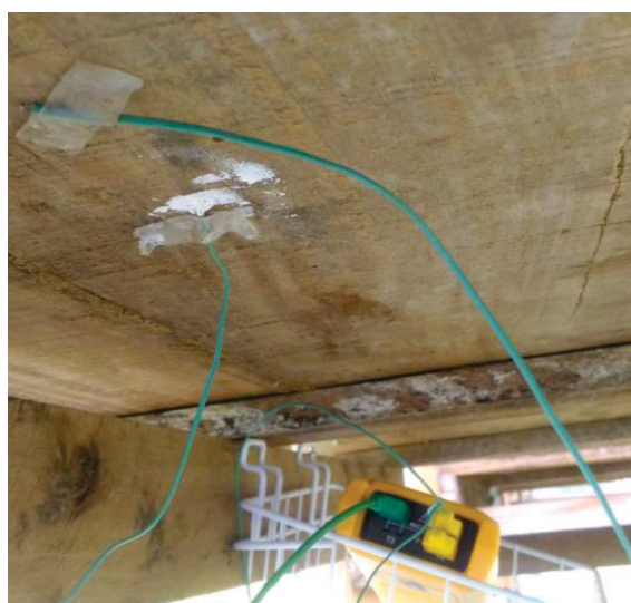
FIGURA 50 TERMÔMETRO INSTALADO NA GAIOLA SOB UM MÓDULO
