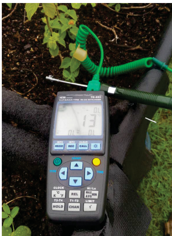
FIGURA 48 TERMOPAR NA SUPERFÍCIE DO MÓDULO
