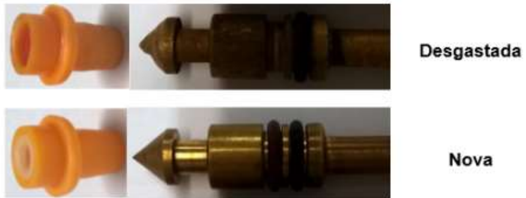
Figura 6 – Assento de vedação e agulha desgastada e nova
