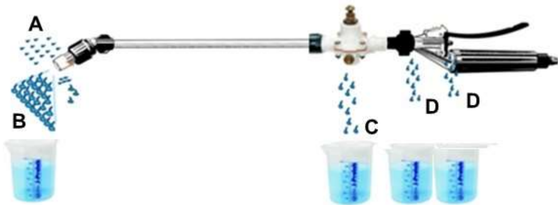
Figura 4 – Locais de coletas dos vazamentos do equipamento.
