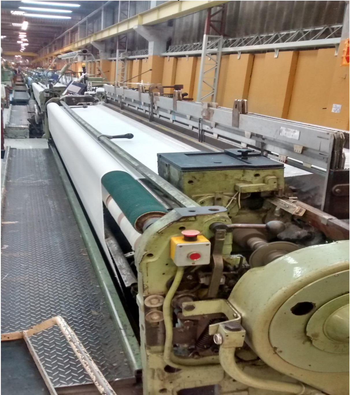
FIGURA 1- TEAR SULZER RUTI 183" EM PRODUÇÃO
