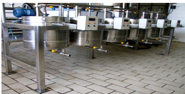
Figura 13 - Reatores biológicos para preparo da biomassa
