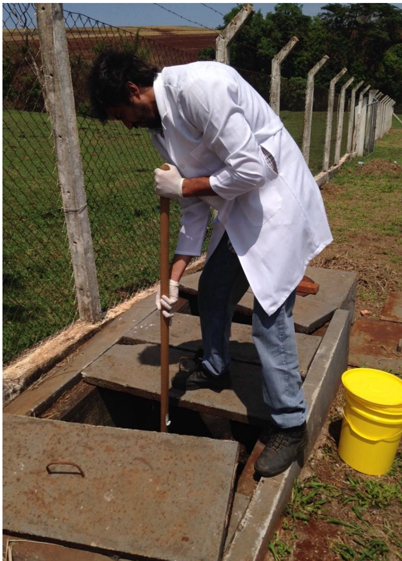
Figura 10 – Foto mostrando o procedimento de coleta de amostras para isolamento dos microrganismos de interesse na entrada do sistema de fossa-filtro
