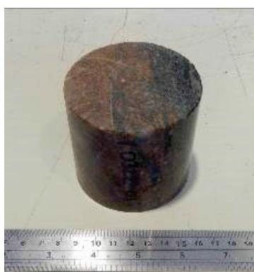
FIGURA 3. FOTO DE UM DOS CORPOS DE PROVA DE ROCHA PREPARADOS PARA O TESTE DE RESISTÊNCIA À COMPRESSÃO UNIAXIAL.
