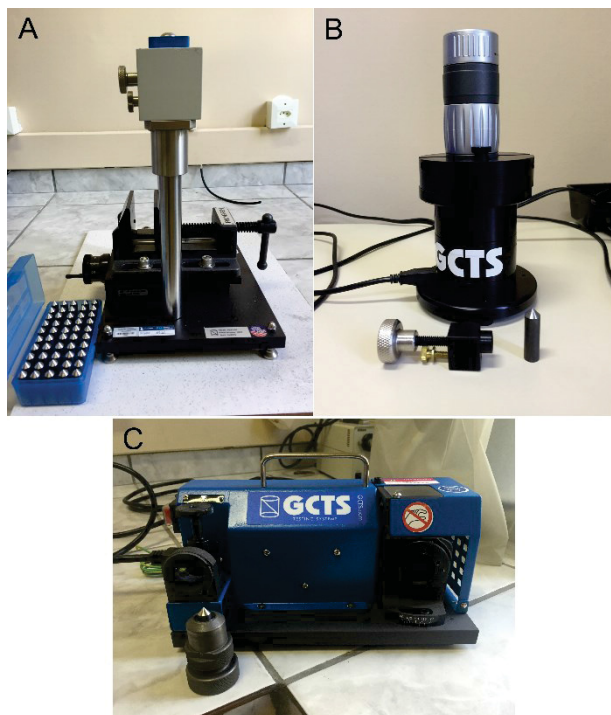
FIGURA 13 A) FOTOGRAFIA DO EQUIPAMENTO CERCHAR RAA-100 INSTALADO NO LABORATÓRIO, B) MICROSCÓPIO RAA-AOM DE IDENTIFICAÇÃO DO DESGASTE DAS PONTEIRAS, C) RETIFICA DE PONTEIRAS GCTS STS-100. FONTE: O AUTOR (2016)
