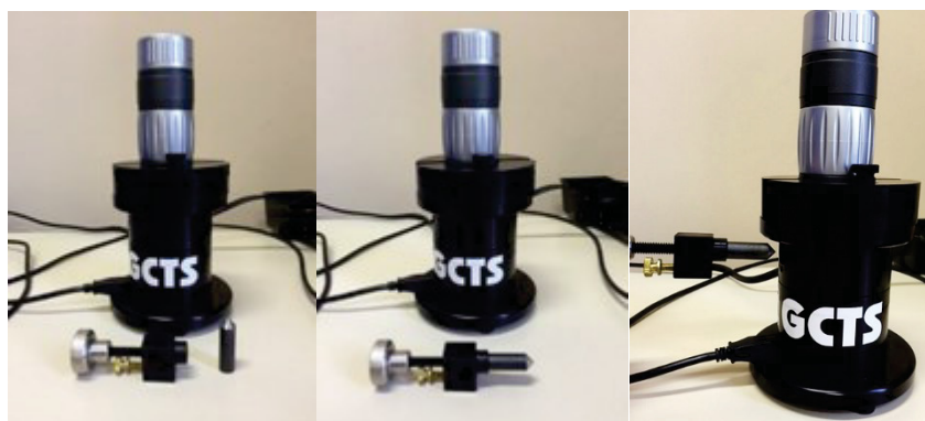
FIGURA 20 SEQUÊNCIA DE IMAGENS DE COLOCAÇÃO DA PONTEIRA NO MICROSCÓPIO PARA REALIZAÇÃO DA LEITURA DO DESGASTE. FONTE: O AUTOR (2016)
