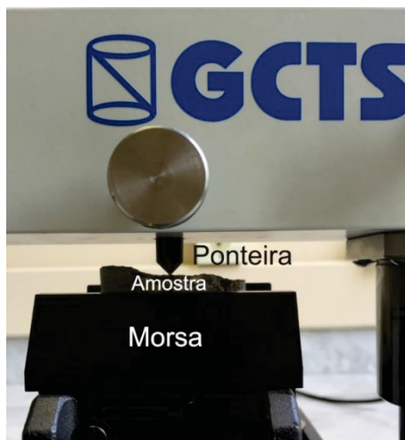
FIGURA 18 DESLOCAMENTO VERTICAL DA PONTEIRA DA POSIÇÃO INICIAL (FIGURA 17) PARA A POSIÇÃO DE REALIZAÇÃO DO TESTE, A PONTEIRA ENCONSTA PERPENDICULARMENTE NA SUPERFÍCIE DA AMOSTRA. FONTE: O AUTOR (2016)
