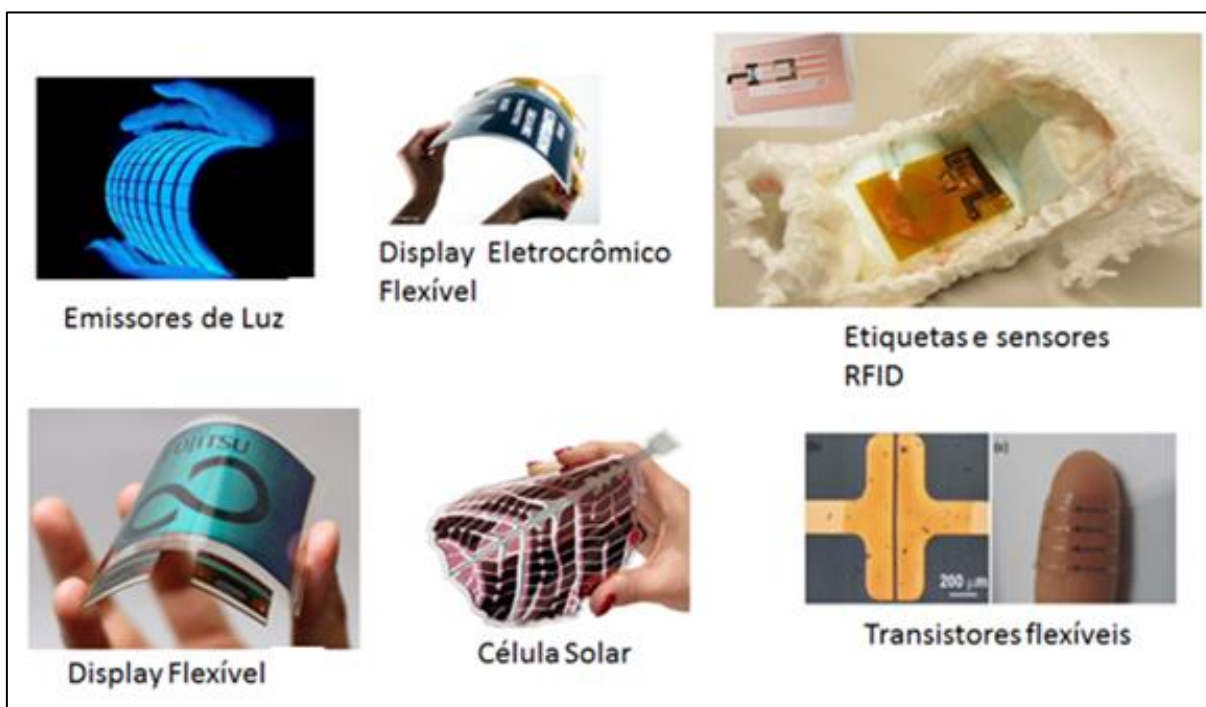
Figura 1: Aplicações comerciais de dispositivos e equipamentos eletrônicos construídos a partir de semicondutores orgânicos
