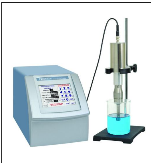
Figura 7: Ultra-sonicador utilizado na fabricação das nanopartículas
