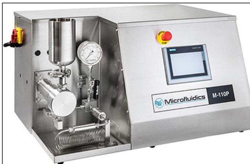
Figura 6: Homogeneizador de alta pressão utilizado na fabricação das nanopartículas
