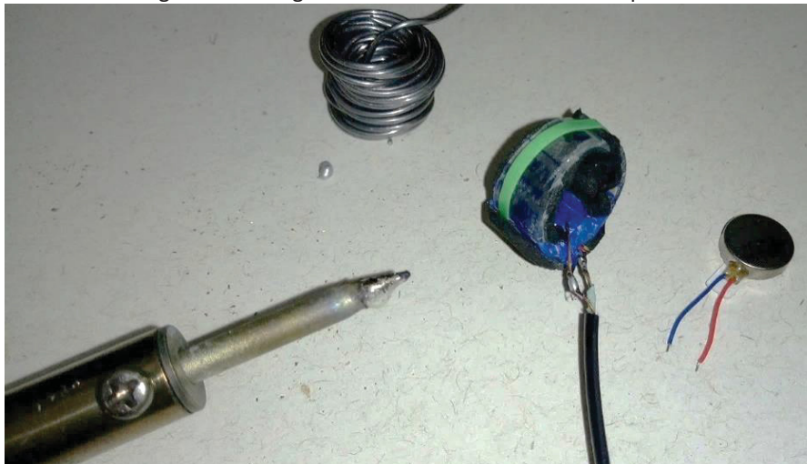
Figura 4 - Soldagem motor vibracional em anel háptico
