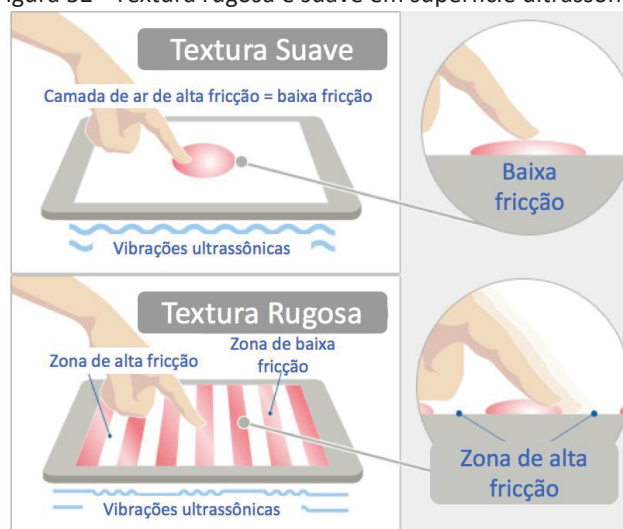
Figura 52 - Textura rugosa e suave em superfície ultrassônica
