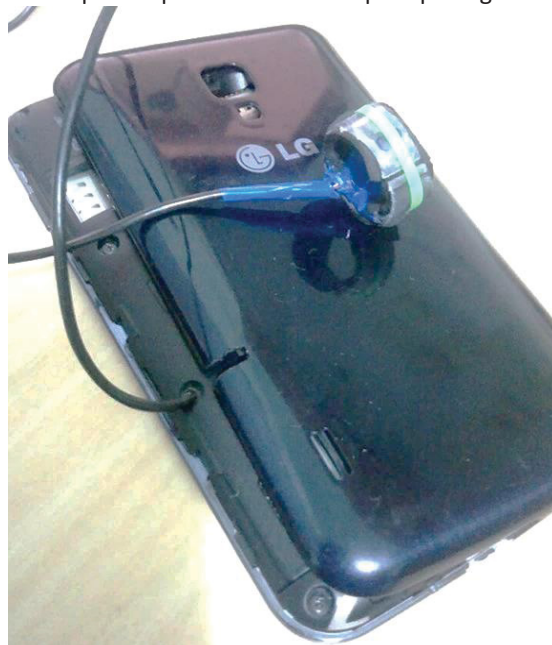
Figura 5 - Capa do aparelho com sulco para passagem do cabo
