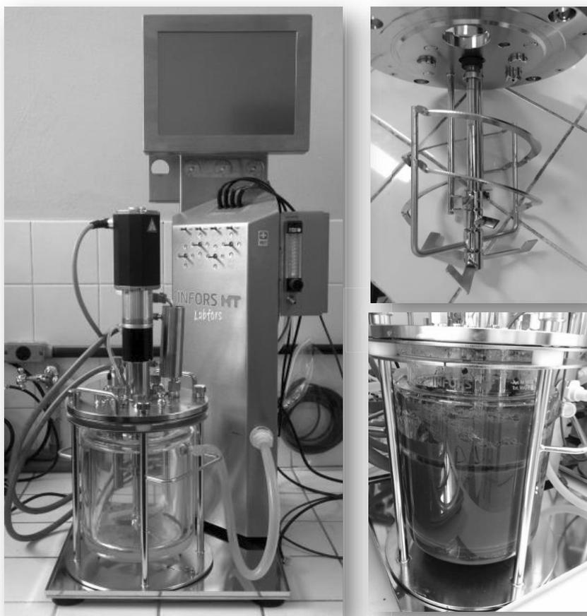
**Figura 11.** Biorreator de bancada utilizado nos experimentos de hidrólise enzimática.
