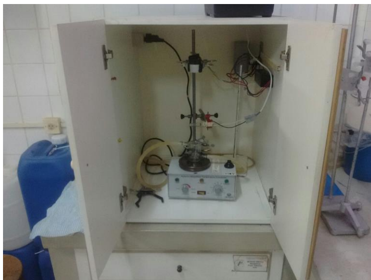
Figura 10. Foto representativa da caixa utilizada para reações de oxidação na presença de radiação luminosa (65 cm de altura, 55 cm de largura, e 55 cm de profundidade) sob tempo controlado. Nos experimentos foi adotada a distância de 7 cm entre a lâmpada e o topo dos frascos de reação.
