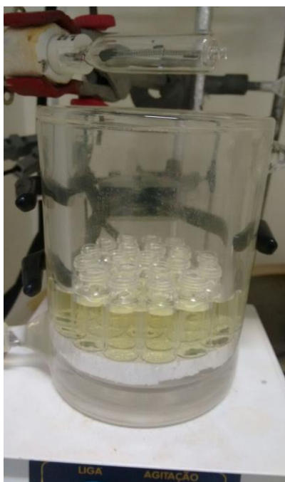
Figura 12. Foto da montagem experimental utilizada na avaliação do rendimento quântico do sistema no qual as reações de fotooxidação foram executadas.
