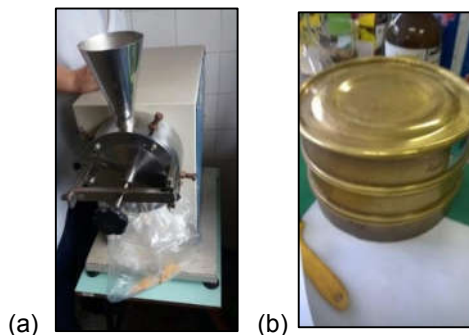
FIGURA 13 - MOINHO DE FACAS TIPO WILLEY E SISTEMA DE PENEIRAS
