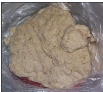
FIGURA 19 - POLPA DE JACITARA BRANQUEADA OBTIDA POR TQ2
