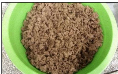
FIGURA 17 – POLPA DE JACITARA OBTIDA DO PROCESSAMENTO EM REFINADOR TIPO BAUER (NÃO-BRANQUEADA)
