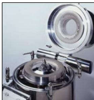
FIGURA 8 - MOINHO DE NANOCELULOSE SUPER MASSCOLLOIDER MASUKO SANGYO
