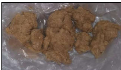
FIGURA 18 - POLPA DE JACITARA BRANQUEADA OBTIDA DO TQ1
