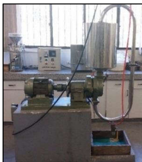
FIGURA 16 – REFINADOR DE DISCOS TIPO BAUER
