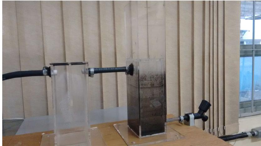
Figura 35: Foto do formador de folhas. A câmara maior é onde se coloca a solução inicial e onde fica armazenada a água excedente (pode ser drenada pela torneira à direita). A câmara menor tem função de conter água que eventualmente venha a escapar do reservatório primário por efeito da diferença de pressão (bomba de vácuo).
