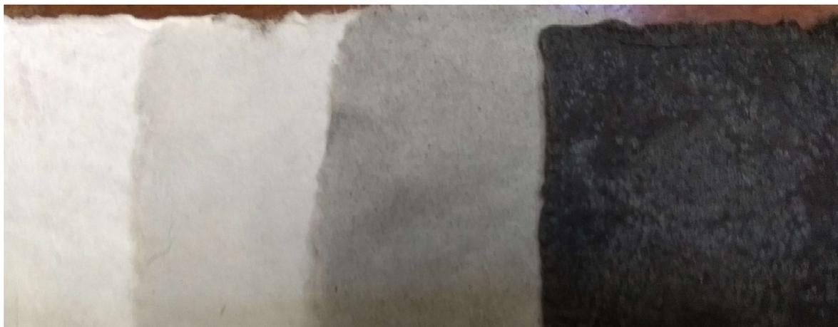
Figura 34: Foto de amostras com diferentes quantidades de CNT incorporadas. Quanto mais escuro o papel, maior a quantidade de CNT incorporada. Após várias amostras produzidas foi possível observar que efeito da incorporação de CNT na amostra é visual.
