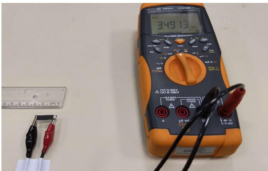
Figura 25: Foto do aparato para medida de resistência utilizando o multímetro
