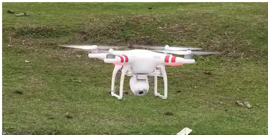
FIGURA 3.2: QUADRICÓPTERO DJI PHANTOM 2 ALIMENTADO POR BATERIA ELECTRÓNICA. FABRICADO PELA DJI INNOVATIONS, É CAPAZ DE TRANSPORTAR UMA CARGA DE 300 g.
