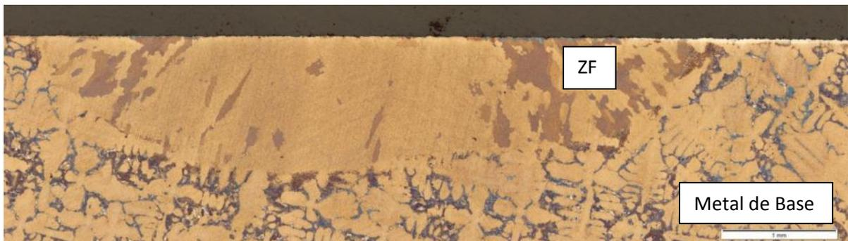
Figura 29: Microestrutura da Amostra 2 (80 A convencional) após TTPS apresentando grãos grosseiros na ZF (escala 1 mm).
