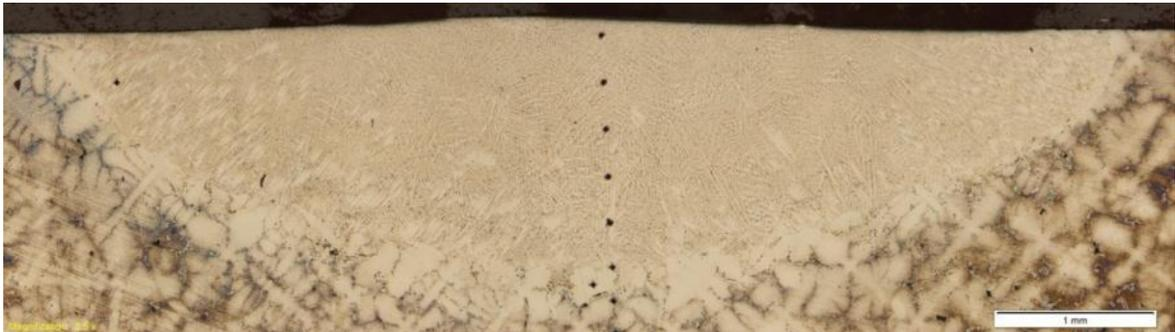
Figura 24: Seção transversal do cordão de solda da amostra 04 (escala 1 mm).
