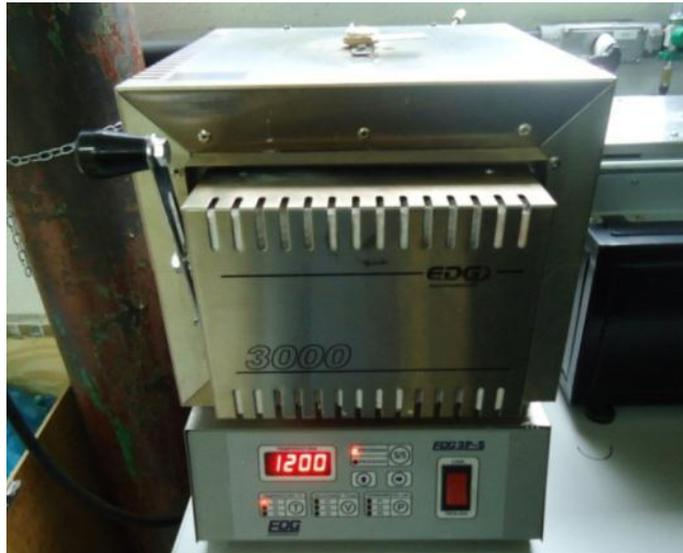
Figura 15: Forno utilizado para o tratamento térmico pós-soldagem.
