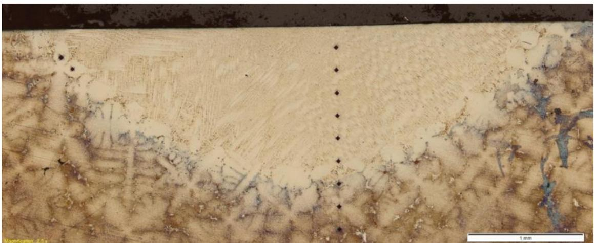
Figura 21: Seção transversal do cordão de solda da amostra 01 (escala 1 mm).
