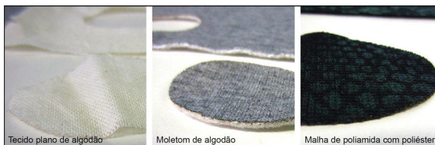
FIGURA 4.13 – Teste de corte a laser em três tecidos diferentes
