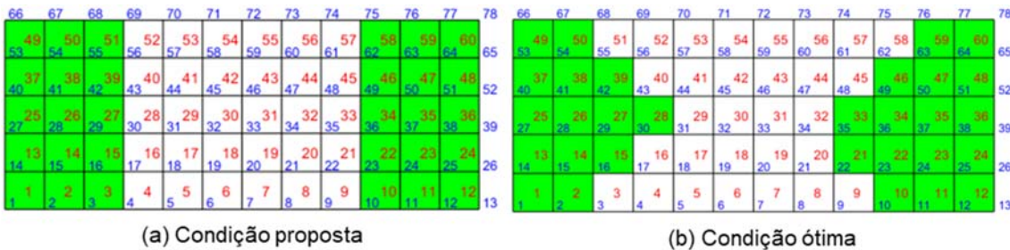
FIGURA 5.33 - SOLUÇÃO PARA O 2º MODO DE VIBRAÇÃO DA PLACA BIAPOIADA COM 50% DE RECOBRIMENTO DE MVE.
