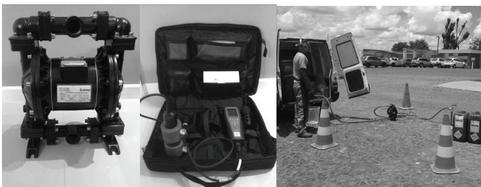
FIGURA 7 - EQUIPAMENTOS DE INJEÇÃO DE OXIDANTE E MONITORAMENTO LOCAL
