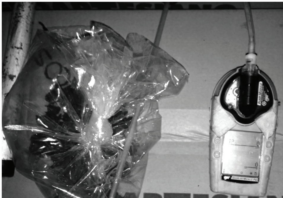
FIGURA 7 - MEDIDOR PORTÁTIL DE GASES GÁSALERTMICROPID5 DURANTE A MEDIÇÃO DE CAMPO, CASO -A
