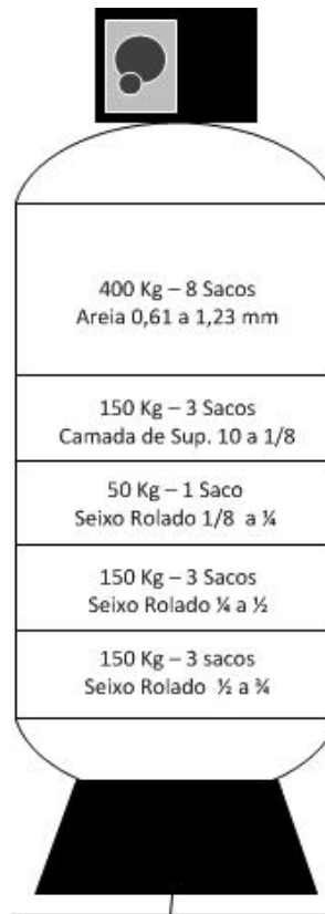
Figura 31 – Organização dos Materiais Filtrantes dentro do FMU
