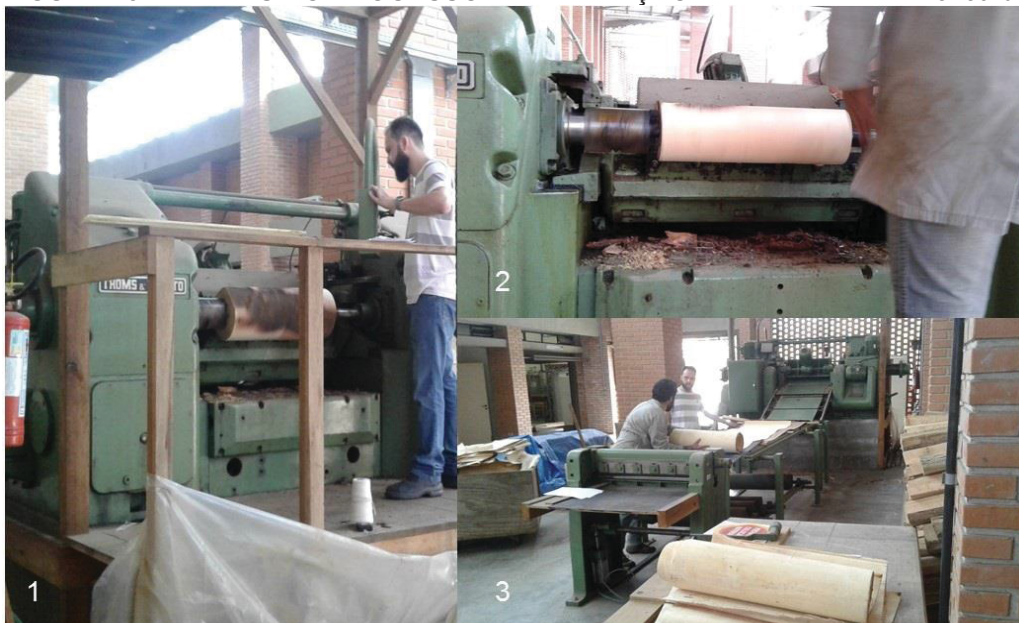
FIGURA 10 – ETAPAS DO PROCESSO DE LAMINAÇÃO DA MADEIRA DE Hevea brasiliensis
