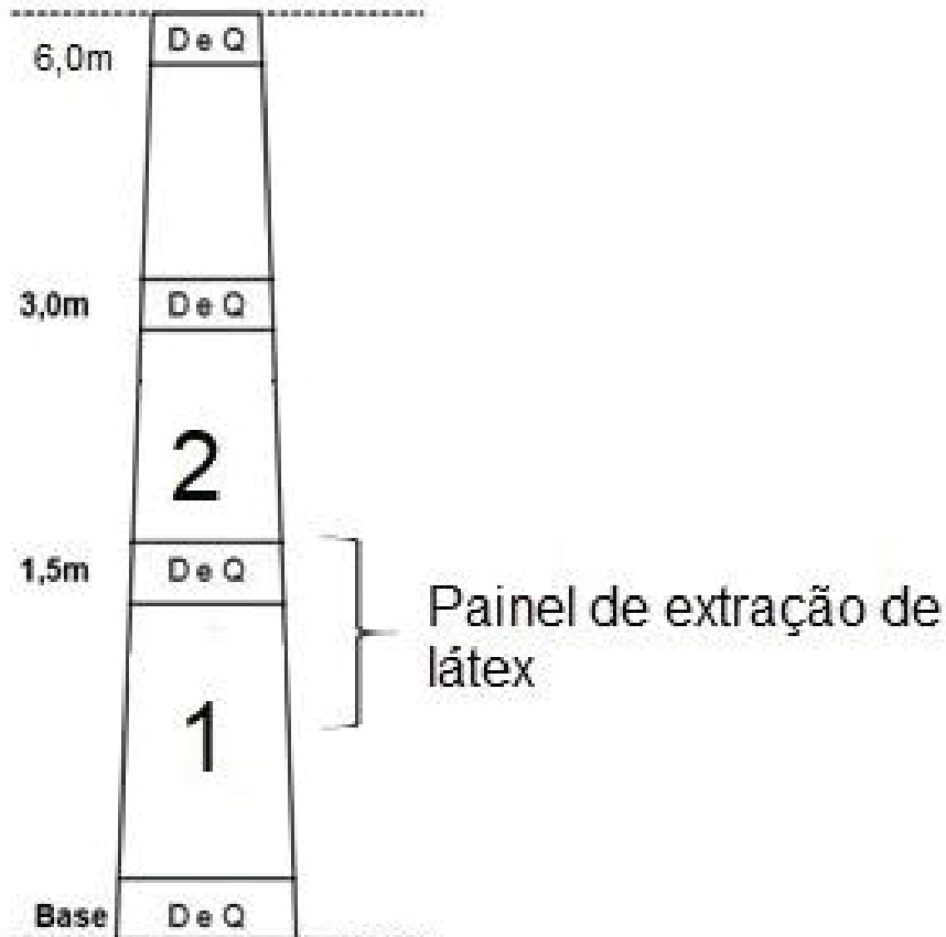
FIGURA 5 – POSIÇÕES DE COLETA DOS DISCOS PARA DETERMINAÇÃO DA DENSIDADE BÁSICA E PROPRIEDADE QUÍMICA DA MADEIRA, E DOS TORETES PARA LAMINAÇÃO
