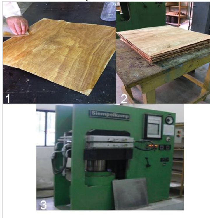
FIGURA 11 – PREPARAÇÃO DOS PAINÉIS COMPENSADOS
