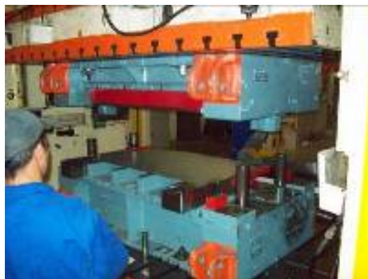
FIGURA 08 - FERRAMENTA DE ESTAMPAGEM, CHAMADA REPUXO FONTE: O autor, 2015
