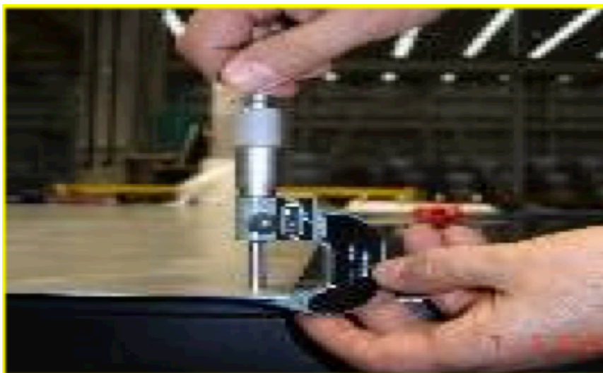
FIGURA 01 - MICROMETRO USADO PARA MEDIR ESPESSURA
