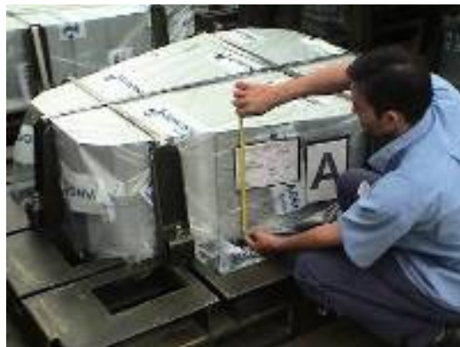
FIGURA 04 - VERIFICAÇÃO DO DIMENSIONAL PARA MONTAGEM DE SETUP
