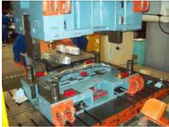
FIGURA 09 - FERRAMENTA DE ESTAMPAGEM, LINHA DE CONFORMAÇÃO FONTE: O autor, 2015
