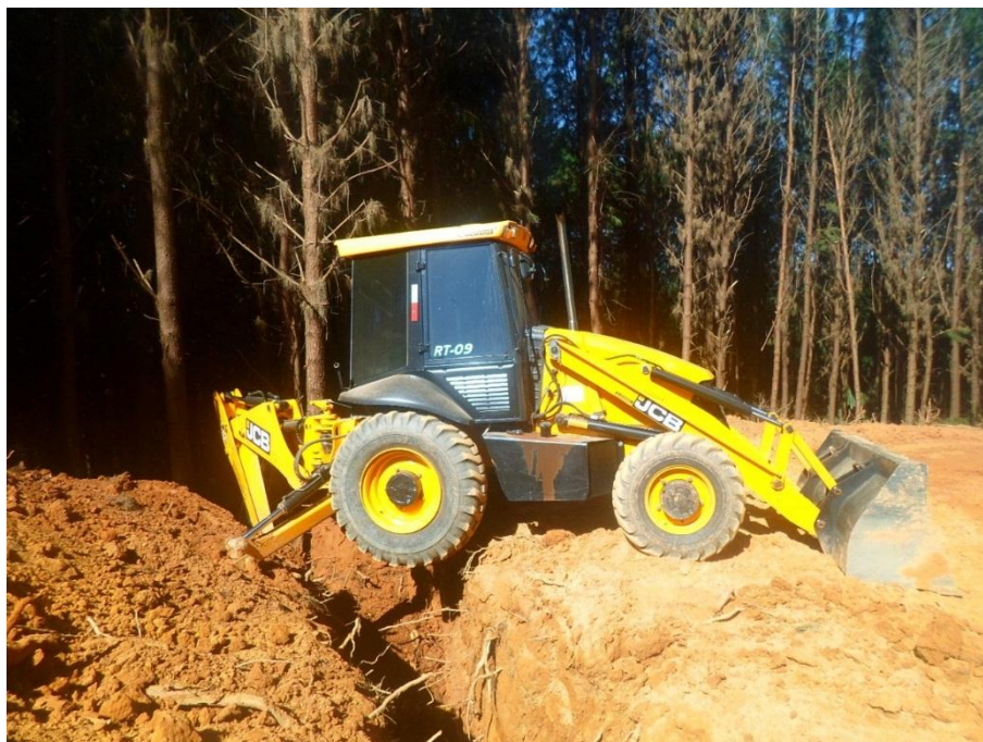
FIGURA 2 - RETRO ESCAVADEIRA FONTE: O Autor (2016)
