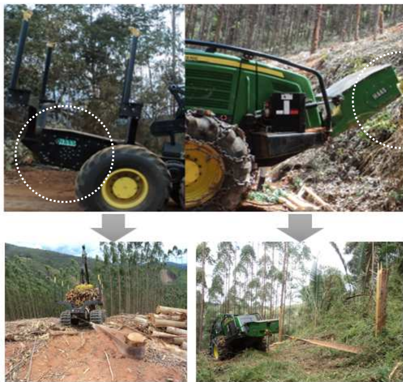
FIGURA 6 – GUINCHO PARA TRAÇÃO EM TERRENOS COM INCLINAÇÃO ENTRE 27° E 35°.
