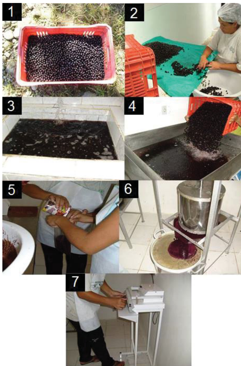
FIGURA 22 – PROCESSO DE DESPOLPA DA ASPRAN NO MUNICÍPIO DE ANTONINA - PR
