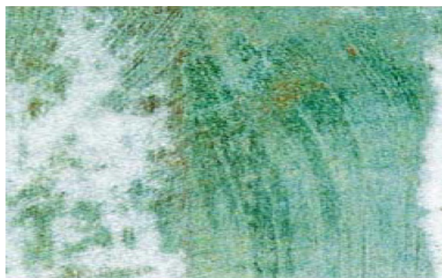
Figura 9 – Manchas e retardamento de secagem quando da pintura ou envernizamento de madeiras, exemplo de defeito na pintura
