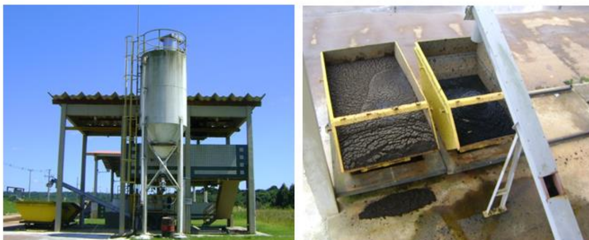
FIGURA 3.6 – OBTENÇÃO DO LODO DE UASB DESAGUADO EM CENTRÍFUGA: A) INSTALAÇÃO LOCAL DE DESAGUE DO LODO; B) TORTA DE LODO DE UASB APÓS O DESAGUAMENTO
