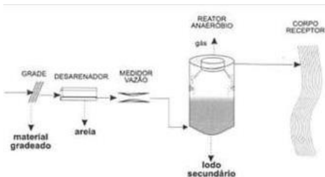
FIGURA 2.2 – TRATAMENTO SECUNDÁRIO POR REATOR ANAERÓBIO
