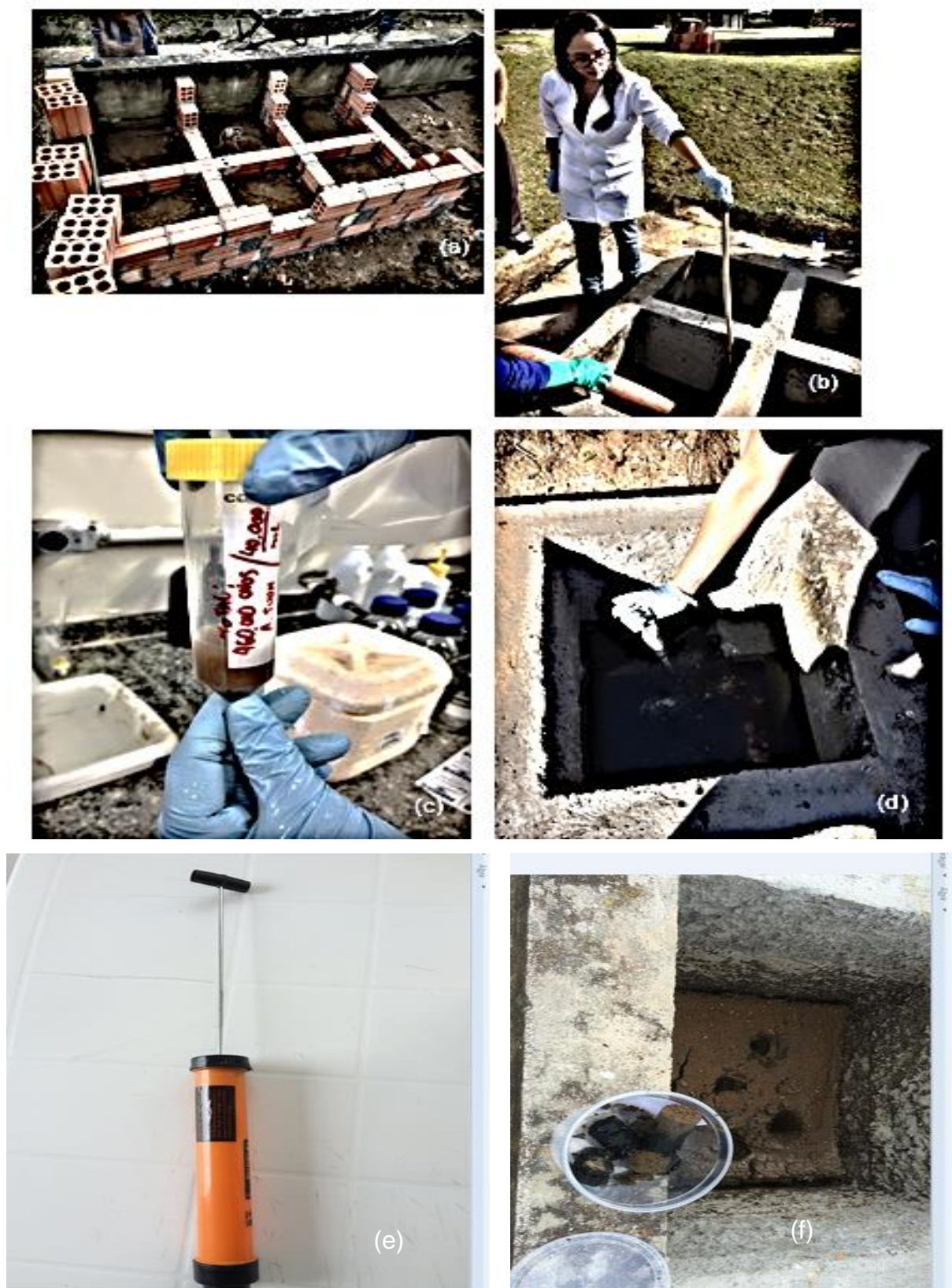
FIGURA 3.15 – LEITOS DE SECAGEM: (A) SUBDIVISÃO DO LEITO DE SECAGEM – LEITOS 1, 2, 3, 4, 5 E 6 (2014) (B)– ENCHIMENTO DOS LEITOS ATRAVÉS DE MANGUEIRA PROVENIENTE DE CAMINHÃO PIPA (C) OVOS DE HELMINTOS CONCENTRADOS (D) INOCULAÇÃO DOS OVOS EM LEITO DE SECAGEM (E) AMOSTRADOR DE LODO (F) AMOSTRA – PERFIL VERTICAL Fonte: O autor (2015)
