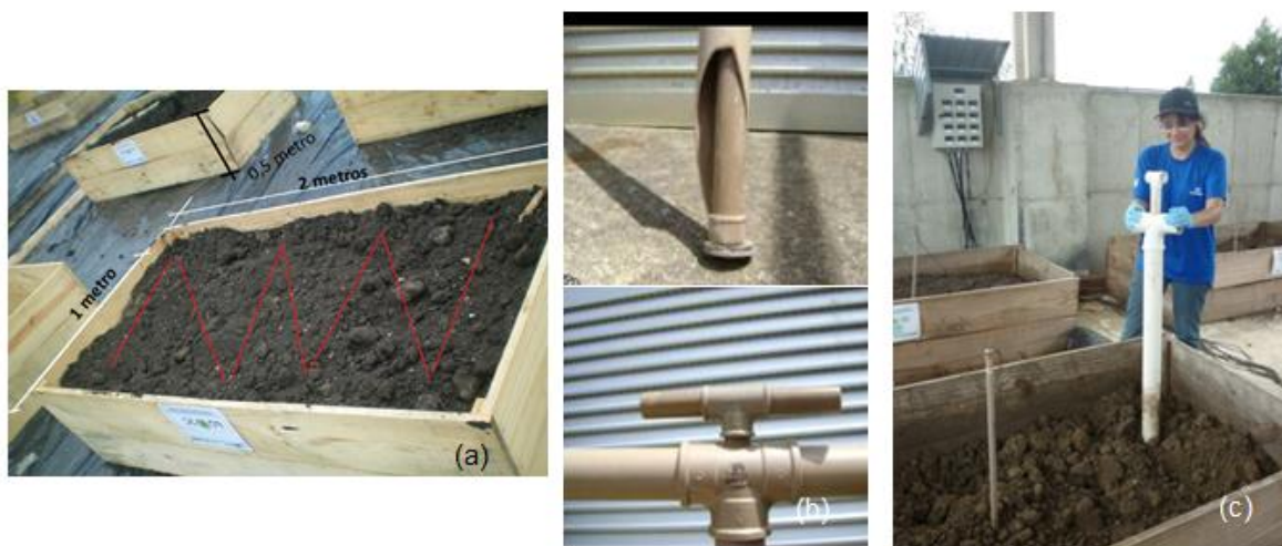
FIGURA 3.12 – AMOSTRAGEM DO LODO NA UNIDADE EXPERIMENTAL: (A) PONTOS DE COLETA; (B) (C) COLETORES DE PVC UTILIZADOS
