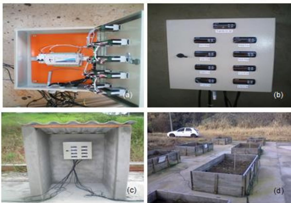
FIGURA 3.13 – MONTAGEM, INSTALAÇÃO DO DATALOGGER E SENSORES DE TEMPERATURA E UMIDADE DO AR (A) INTERIOR DO EQUIPAMENTO; (B) PAINEL DE LEITURA; (C) ABRIGO DO DATALOGGER DE TEMPERATURA E UMIDADE DO AR; (D) SENSORES EM CADA UNIDADE EXPERIMENTAL
