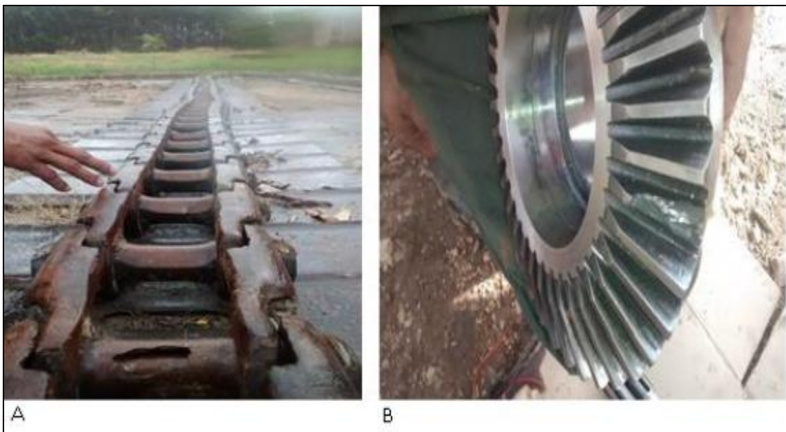
Figura 6 - a) esteira danificada, b) coroa com engrenagem danifica
