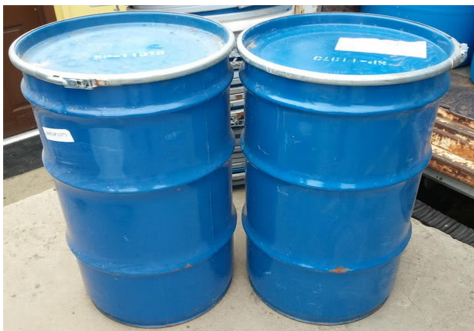
FIGURA 7- TAMBORES DE COLETA DE MATERIAIS TÓXICOS.
