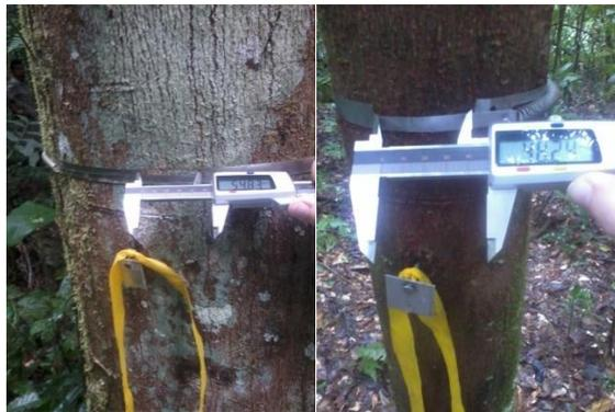
Figura 1. 20 - Avaliação do incremento em circunferência do tronco de espécies arbóreas da Floresta Atlântica, com o uso de cintas dendrométricas permanentes (dendrômetros manuais).
