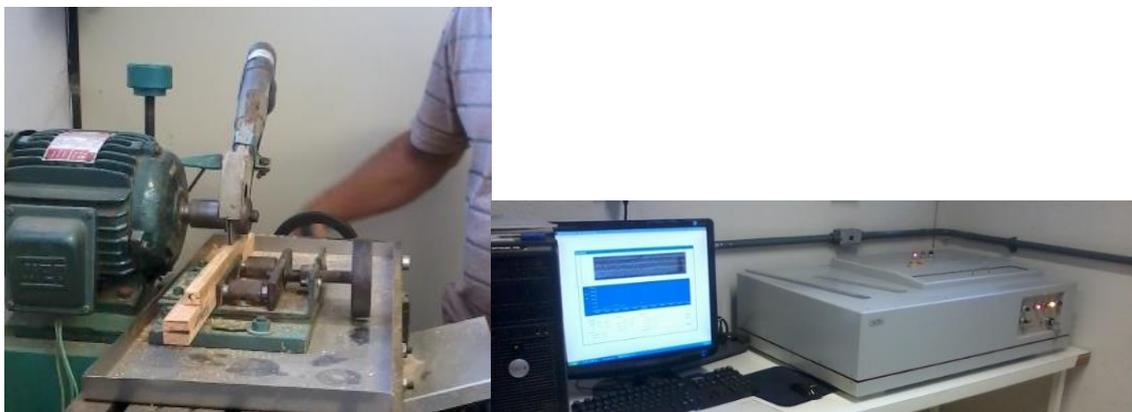
Figura 1. 22 - Preparação das amostras de lenho para leitura da densidade aparente, com a densitometria de raio-X, em aparelho QTRS-01X (Tree Ring Analyzer), no Laboratório de Anatomia, Identificação e Densitometria de Raios X em Madeira, ESALQ/USP em Piracicaba, SP.
