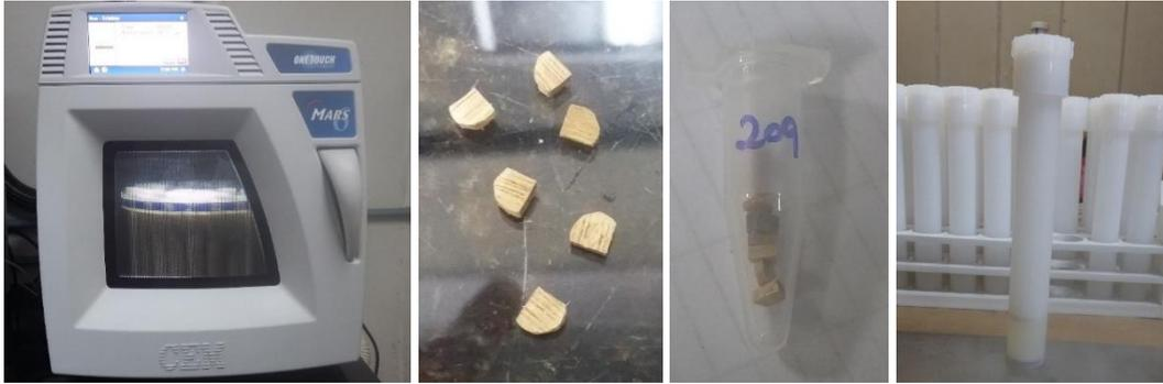
Figura 1. 23 - Digestão de amostras do lenho, em forno micro-ondas modelo MARS6, para determinação dos macronutrientes e micronutrientes, no Laboratório de Mineralogia do Solo/DSEA/UFPR.
