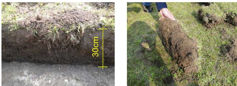
Figura 20: Substrato existente na edificação de telhado verde. Fonte: A autora (2011).
