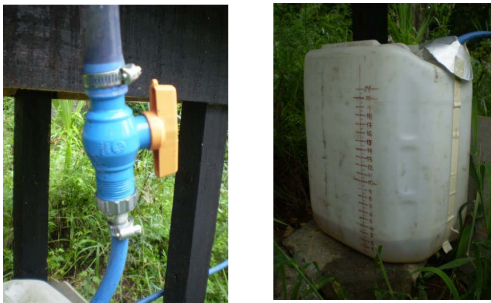
Figura 36: Detalhe do registro e recipiente graduado. Fonte: A autora (2011).
