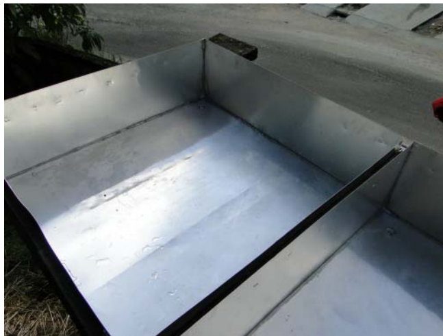
Figura 27: Caixa impermeável com fundo de 1m 2 . Fonte: A autora (2011).
