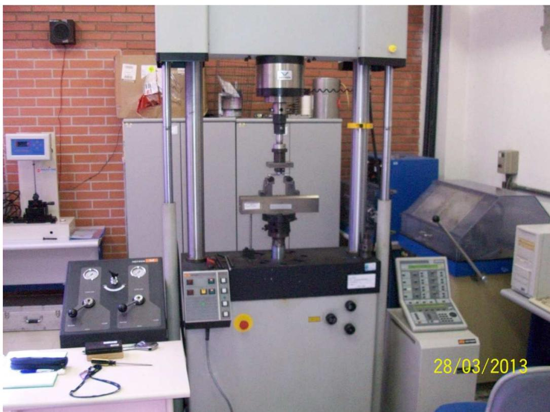
**Figura 3.3 - Equipamento de ensaio de fadiga.**
