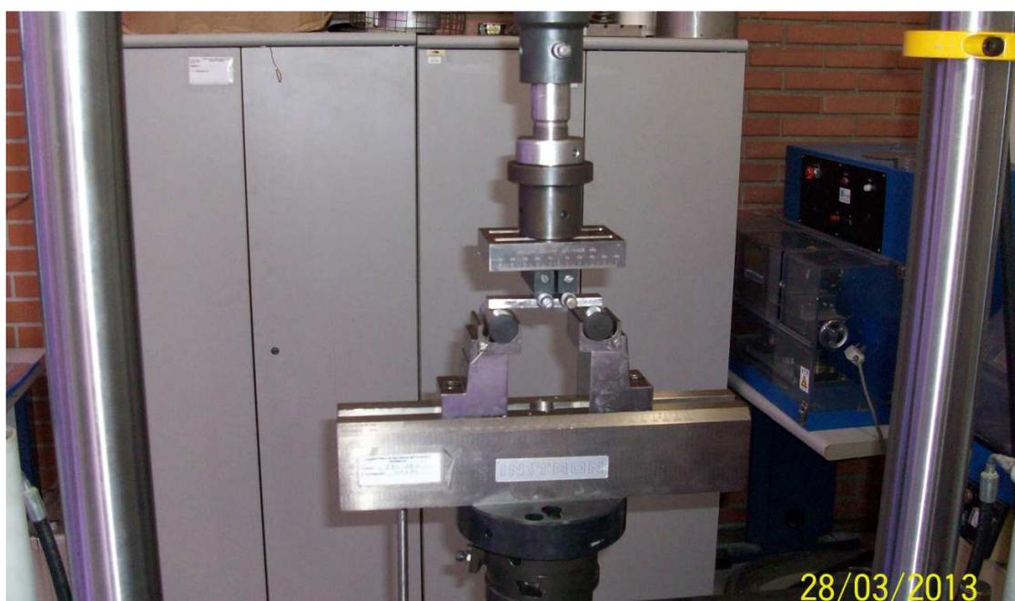
**Figura 3.4 – Dispositivo para ensaio de fadiga por flexão em quatro pontos.**
