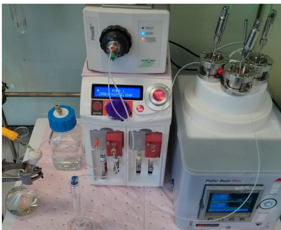
Figura 14: Fotografia do sistema utilizado na alquilação de Carreira utilizando 3 reatores tanque de agitação contínua.
