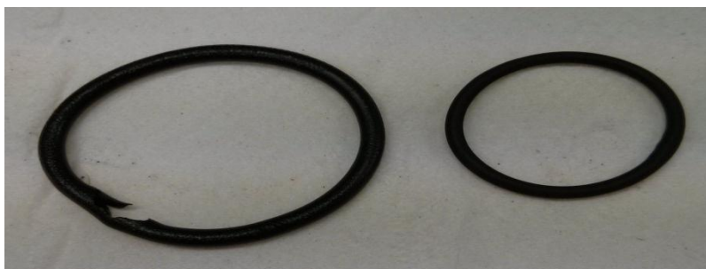
Figura 24: Anéis de borracha da bomba de duplo pistão após o contato por 12 h com solução de hidrazina 1 mol/L em THF (esquerda) e THF (direita).
