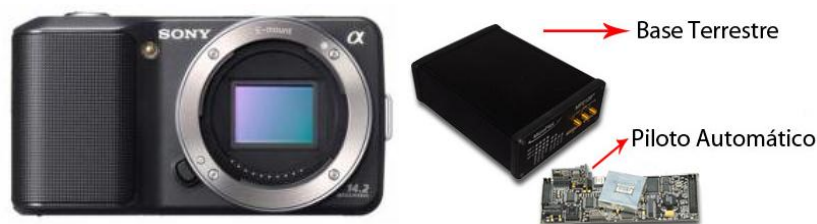
Figura 11 - Câmera fotográfica acoplada no Vant e o Sistema Sama. (Fonte: Sony, 2012)
