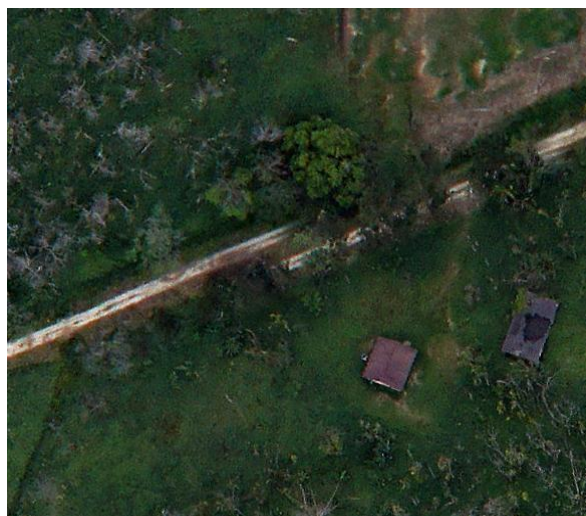
Figura 17 - Falha na junção das aerofotografias. Fonte: (SIMEPAR, 2013)
