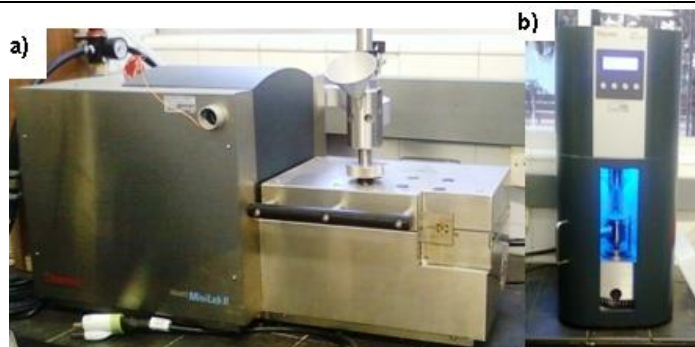
FIGURA 20: IMAGENS DA MICROEXTRUSORA a) E MICROINJETORA b) UTILIZADOS NA PREPARAÇÃO DOS CORPOS DE PROVA.
