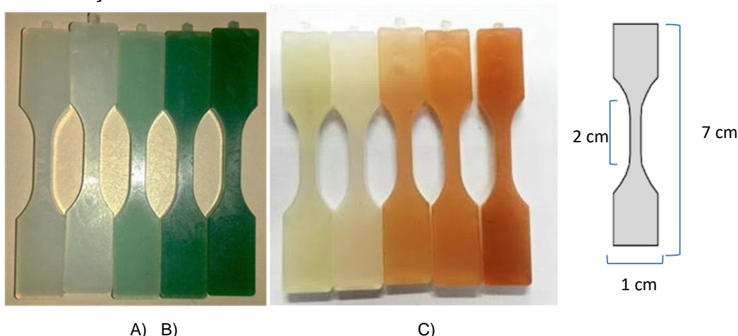
FIGURA 21: FOTOS DIGITAIS DOS CORPOS DE PROVA. COMPÓSITO DE PEBD CONTENDO HDL DE Ni/Al (A); HDL DE Co/Al (B) e MEDIDAS DO CORPO DE PROVA, CONSIDERANDO ESPESSURA 3,27 mm (C).
