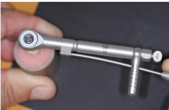
Figura 2 – Fixação dos implantes (a) ; Corpo de prova finalizado (b).
