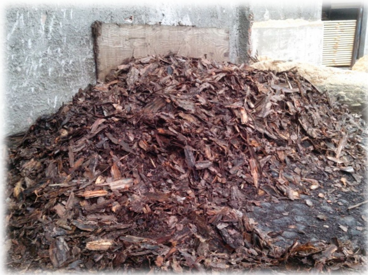
FIGURA 5 - Sobras de casca geradas no processo de serragem das toras.
