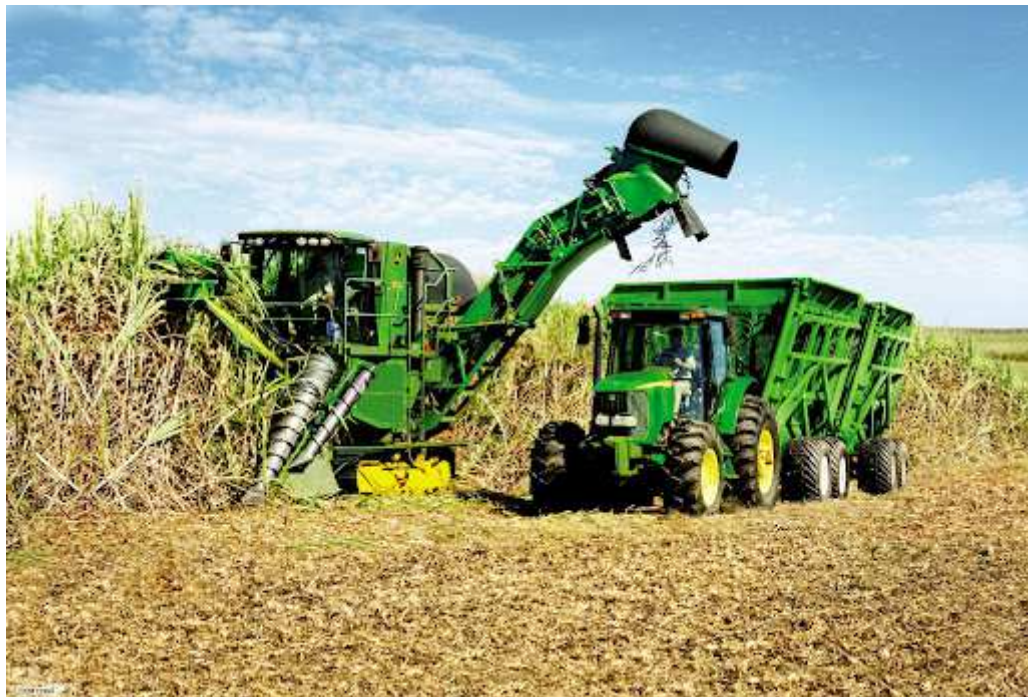
FIGURA 6 – COLHEDORA DE CANA EM OPERAÇÃO
