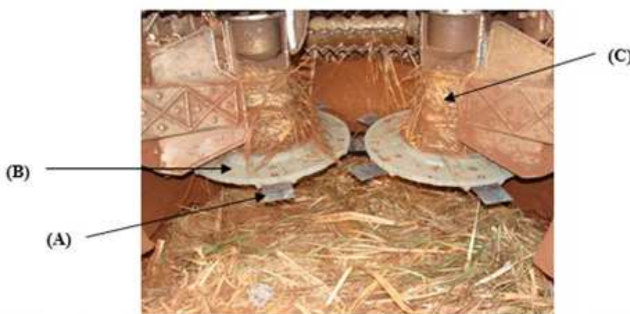
FIGURA 4 – MECANISMO DE CORTE BASAL DA CANA
