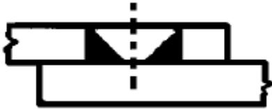
FIGURA 4.12 - Exemplo de solda de filete em furo ou rasgo. (EUROCODE 3 – 1996)
