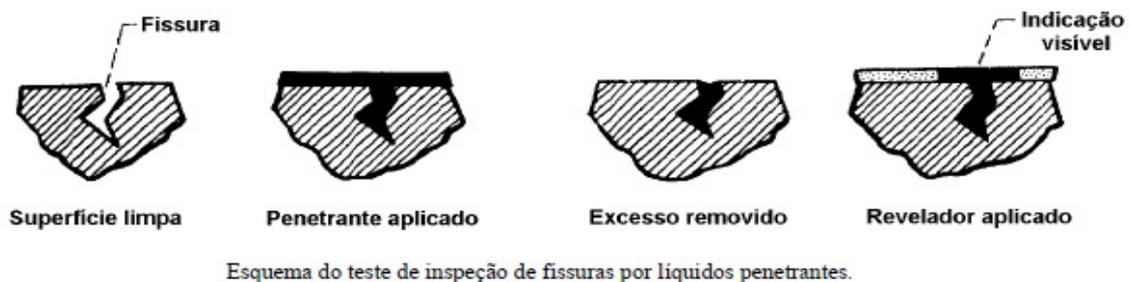
FIGURA 7.10 - Esquema do teste de inspeção de fissuras por líquidos penetrantes. (OWENS – 1989)
