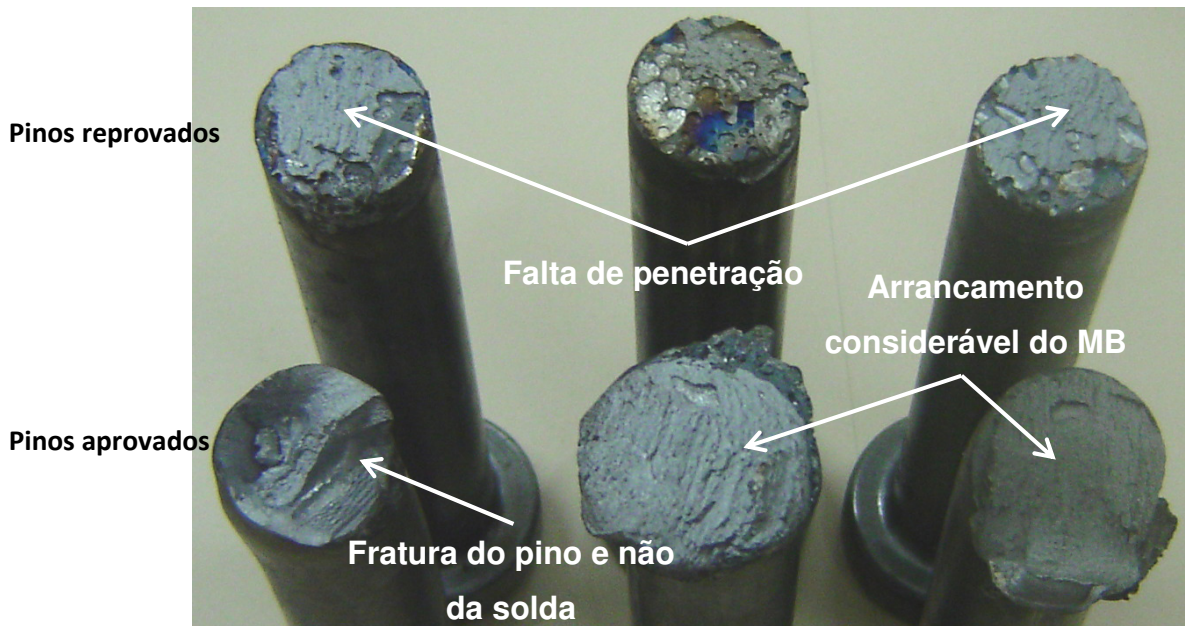
Figura 13. Avaliação da quebra do pino no teste de dobramento
