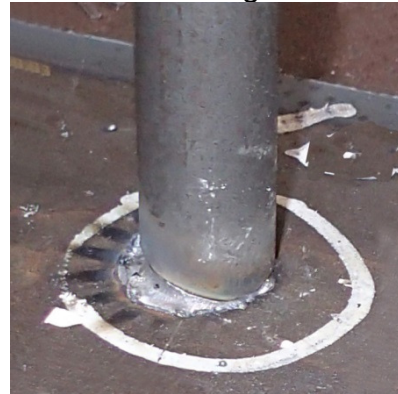
Baixa corrente de soldagem
