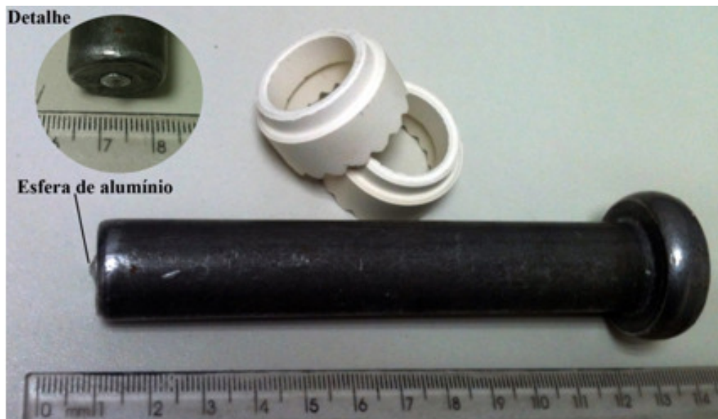
Figura 5. Detalhe construtivo dos pinos
