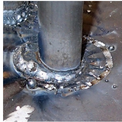
Corrente de soldagem elevada
