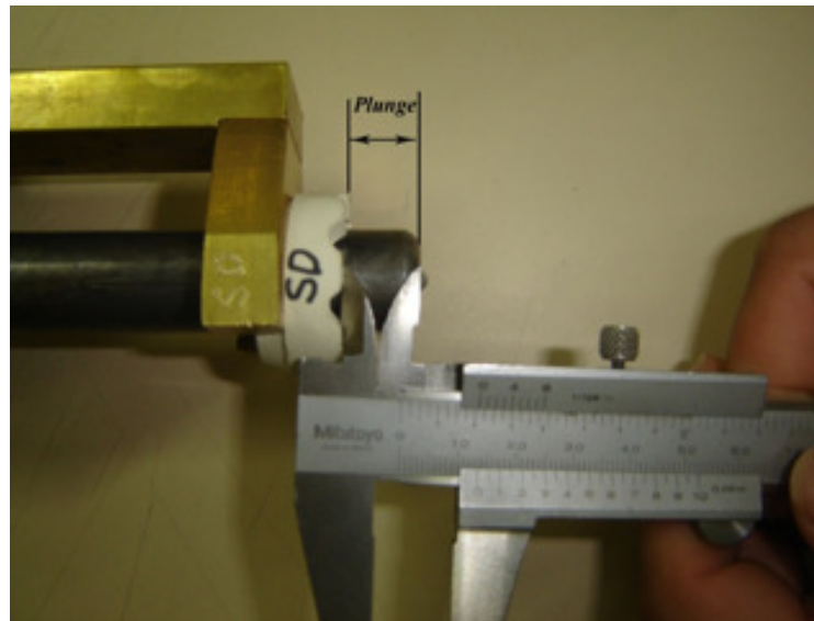
Figura 7. Medição do plunge
