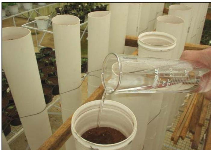
FIGURA 20 – DETALHE DOS FRASCOS UTILIZADOS PARA A COLETA DA SOLUÇÃO PERCOLADA (GARRAFA) E PARA ARMAZENAGEM EM CONGELADOR (POTE)
