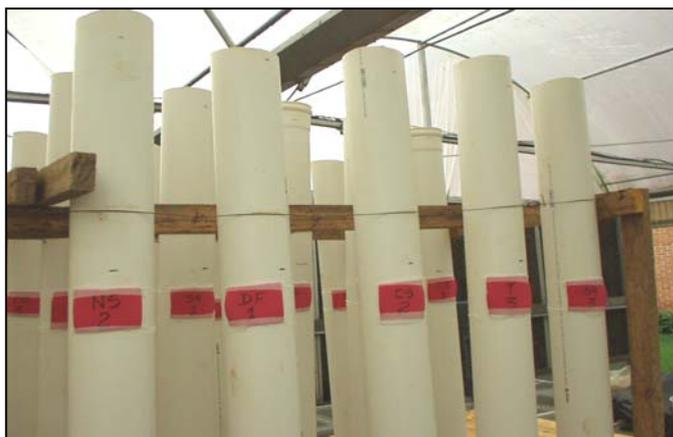
Os tubos foram fechados em sua parte inferior com tampa de PVC, no centro das quais efetuou-se orifício de 1 cm de diâmetro que serviu para escoar a água percolada através da coluna de solo. Na parte interna das tampas instalou-se pedaço de tecido sintético, novo e limpo, que serviu como filtro para a água percolada, evitando-se assim a presença de particulados na solução a ser analisada (Figura 15).
