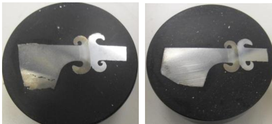
Figuras 55 e 56. Formato das rebarbas das amostras 2b e 2c
