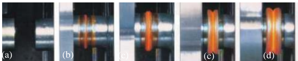
Figura 3: Fotos da sequência básica da Soldagem por Fricção Convencional (Manual ETA FW)
