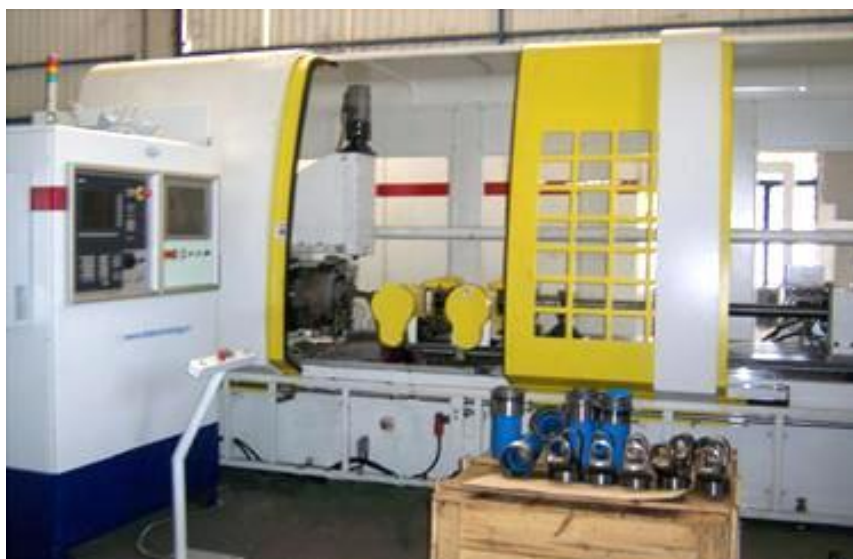
Figura 25. Equipamento de solda fricção utilizado neste trabalho
