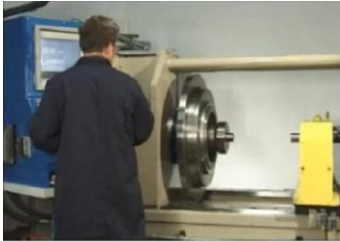
Figura 7. Exemplo de uma máquina de soldagem por Fricção Inercial
