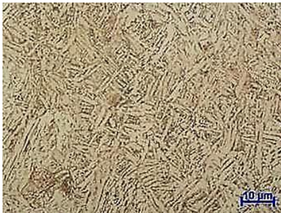
Figura 80. ZTA Tubo Amostra 1a (Nital 3%, 500x) Figura 81. ZTA Garfo Amostra 1a (Nital 3%, 500x)
