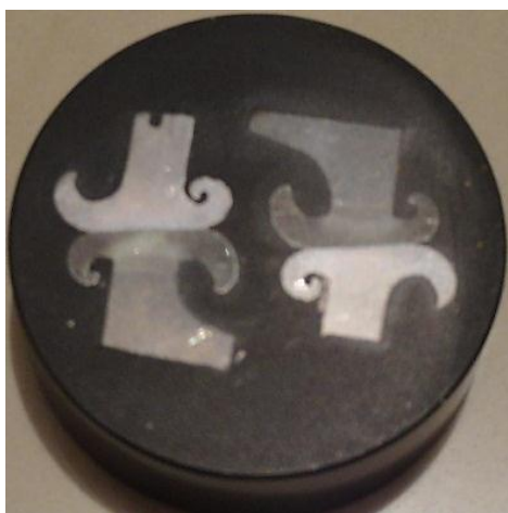
Figura 35. Exemplo de corpo de prova embutido em baquelite, lixado, polido e atacado com Nital 3%
